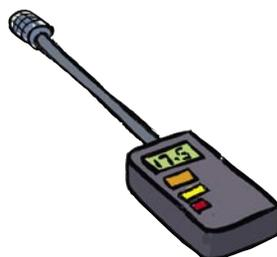
Ces appareils sont composés de capteurs (ou sondes) reliés à une unité centrale d'exploitation, munie d'alarmes sonores ou visuelles qui se déclenchent en cas de dépassement des seuils permis.
